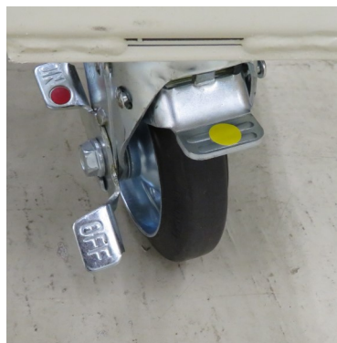
図3 キャスター旋回（自在）・固定切替機構 （ペダル上げ：固定、ペダル下げ：旋回（自在））
