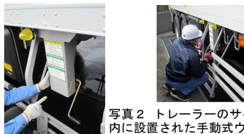
写真2 トレーラーのサイドガード内に設置された手動式ウインチ
