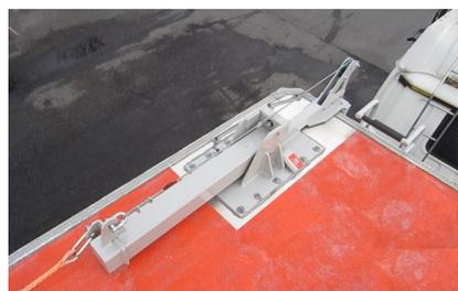
墜落転落防止用装置が倒れている状態
