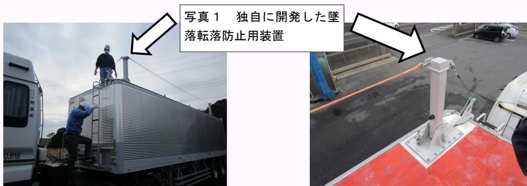
写真1 独自に開発した墜落転落防止用装置
