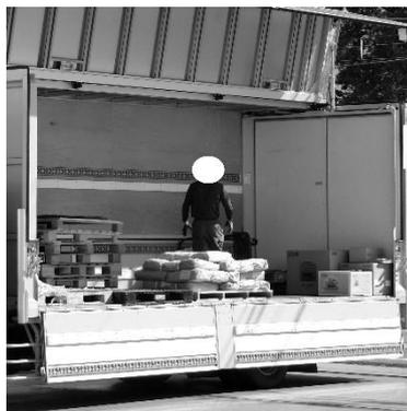
図1 作業者の昇降設備がない例（ウイング車）
