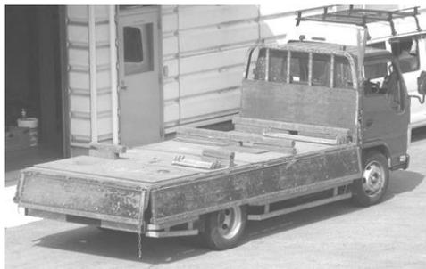
図1 作業者の昇降設備がない例（平ボディ車）
