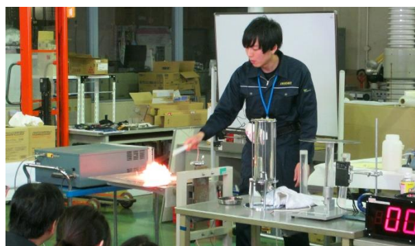
実演実験「静電気の帯電・放電・着火実験」
