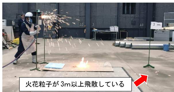
実演実験「ガス溶断作業における爆発・火災の危険性」
