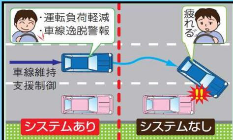
走行車線を認識し、車線から逸脱しそうになった場合には、運転者が車線中央に戻す操作をするよう警報します。
