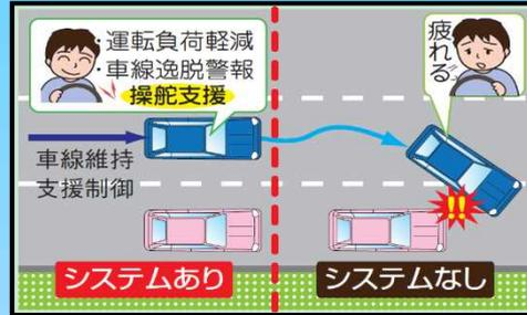
走行車線を認識し、車線維持に必要な運転者の操舵力を軽減します。車線から逸脱しそうになった場合には、運転者が車線中央に戻す操作をするよう警報します。
